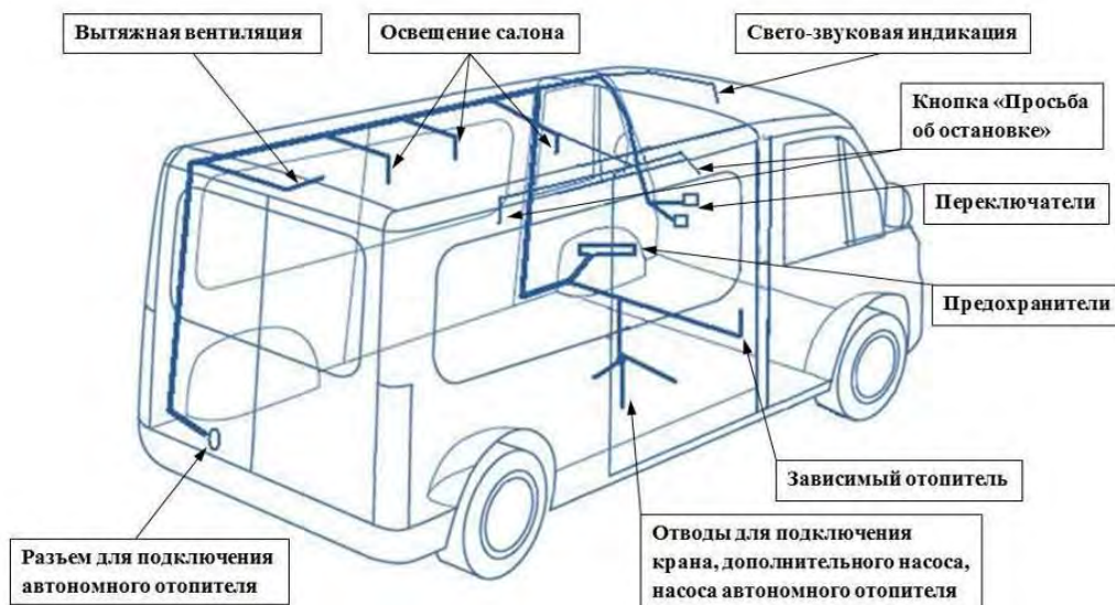
Рисунок 4. Основной жгут электропроводки (под обшивкой, вдоль левого борта салона).
