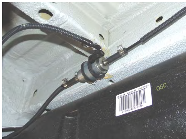
Рисунок 24. Топливный насос Webasto, вблизи топливного бака.
