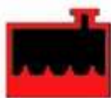
Рис. 8.1. Индикатор, сигнализирующий критический уровень охлаждающей жидкости в расширительном бачке
