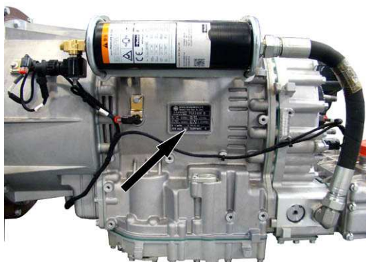
Рис. 1.6. Установка идентификационной таблички АКП FC6A185R
