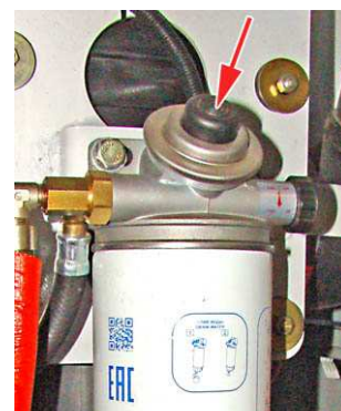
Рис. 4.1. Подкачивающий насос на топливном фильтре
