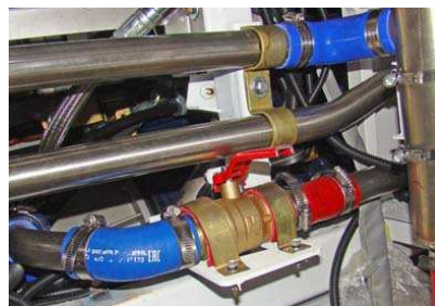
Рис. 8.5. Доступ к крану через люк на левой боковине
