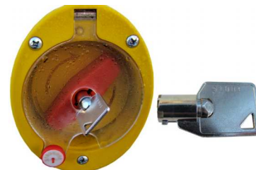
Рис. 8.17. Ключ управления краном аварийного открытия двери, без нарушения пломбы
