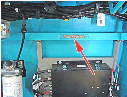
Рис. 1.4. Установка дублирующей таблички с идентификационным номером автобуса в мотоотсеке
