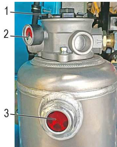
Рис. 8.8. Гидробак системы: 1 – крышка масляного фильтра; 2 – манометр 3 – смотровое окно
