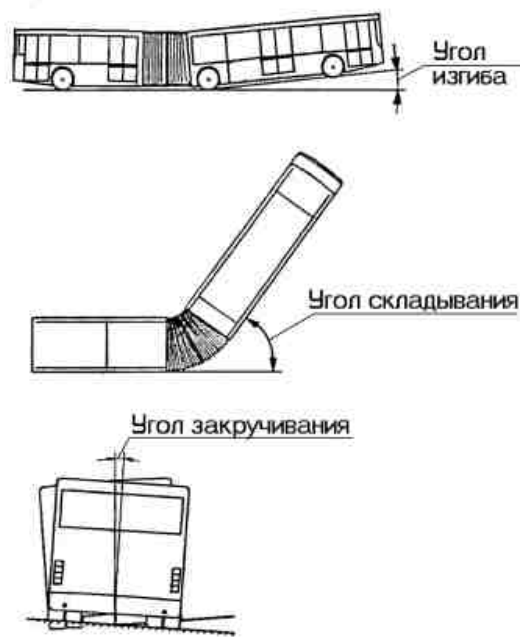
Рис. 4.3. Возможные взаимные положения секций автобуса
