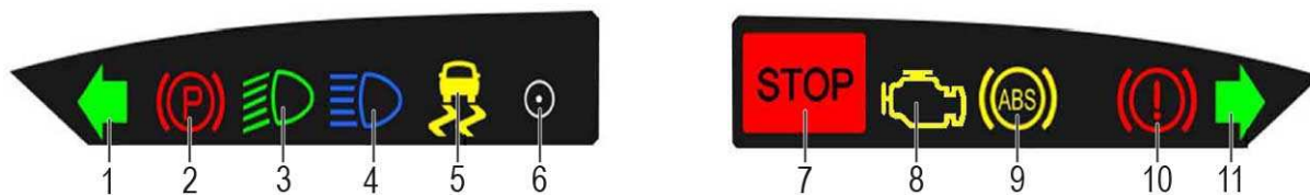
Рис. 3.9. Блоки световых сигнализаторов
