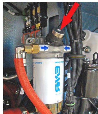
Рис. 4.1. Подкачивающий насос на топливном фильтре
